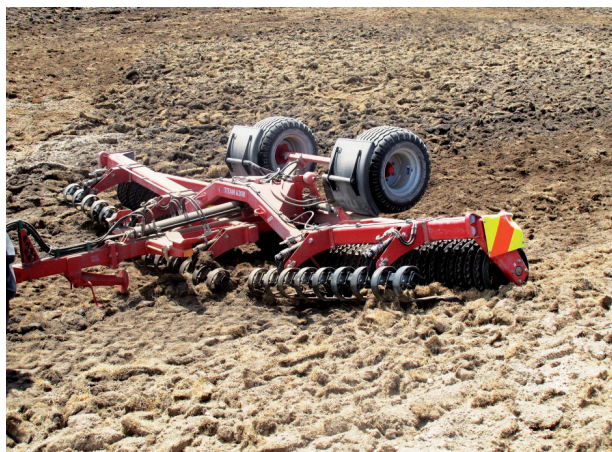
Výkyv křídel rámu je až 30 cm. (Ausschwenkung der Rahmeflügel bis 30 cm).
