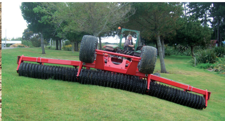
Výkyv křídel rámu je až 30 cm. (Ausschwenkung der Rahmeflügel bis 30 cm).
