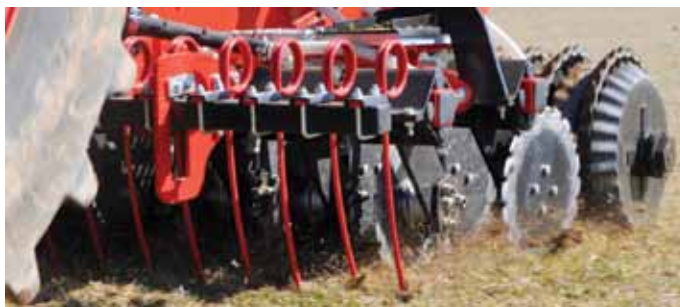
Zavlačovač k přípravě setového lůžka vyčesává stařinu a předpřipravuje drážku pro každou diskovou botku.
