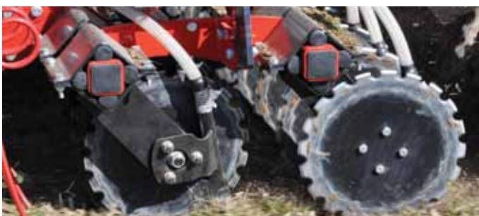
Diskové secí botky uložené pomocí tuhých pryžových silentbloků. Rozměr disku je 410 mm x 5 mm.
