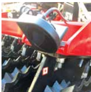
Automatická úprava dávkování dle rychlosti pomocí senzorů.
